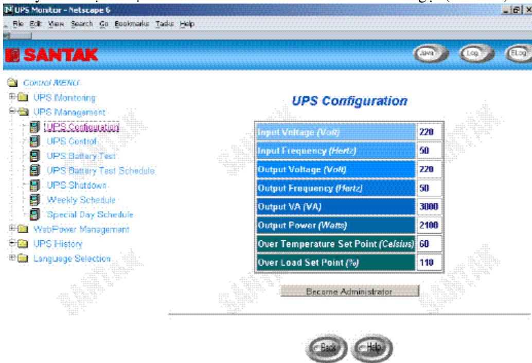
Hình 18 Trang màn hình cấu hình Webpower UPS
