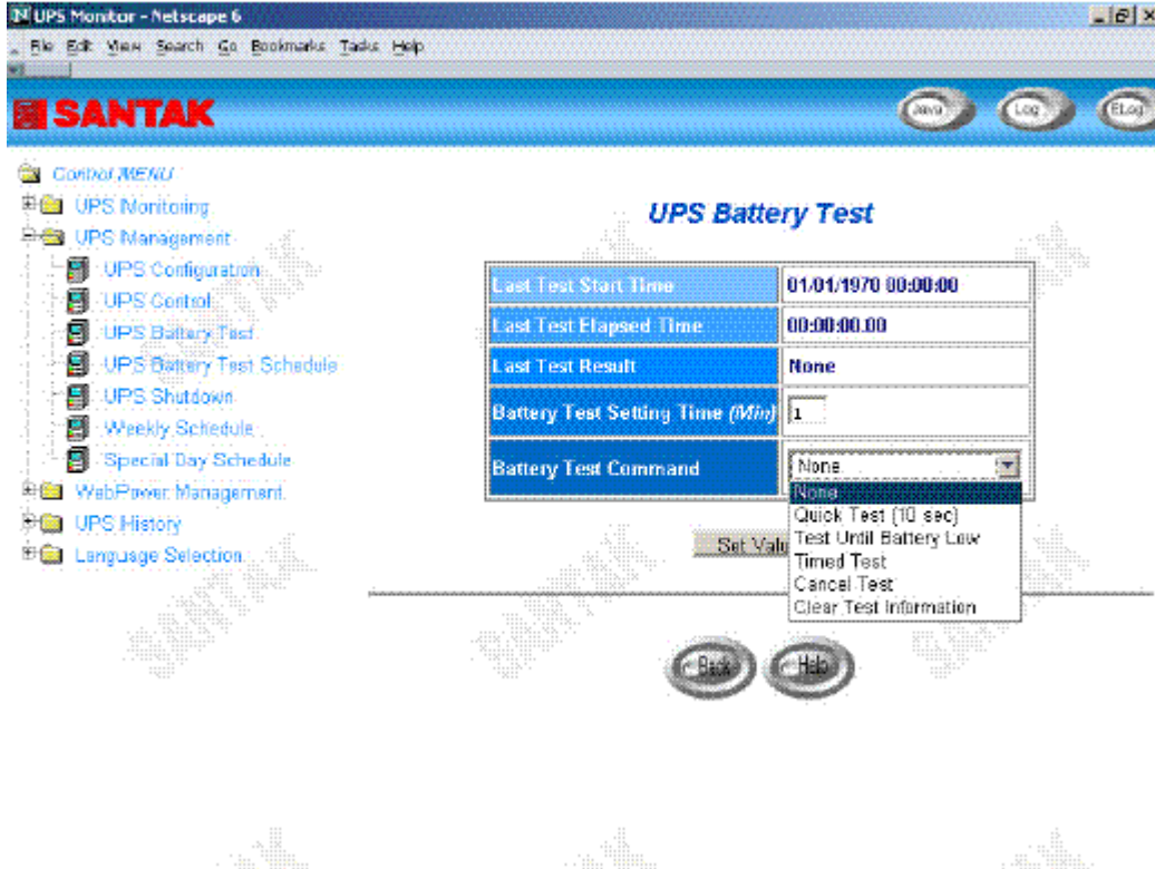
Hình 20 Kiểm tra pin UPS Webpower
